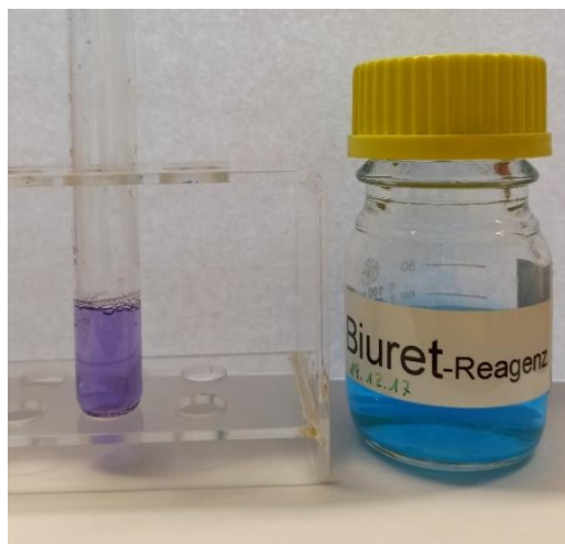
Abbildung 2: Biuret-Probe: Lösung von Wasser und Gelatine violette Färbung (links), Biuret-Reagenz blaue Färbung (rechts) [eigenes Foto]
