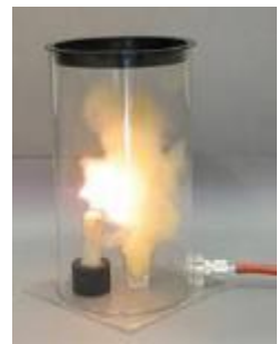
Abb. 3: Explosion im Plexiglas-Silo
