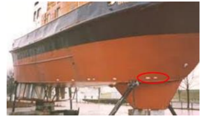
Abb. 5: Opfer-Anoden an Schiffen (Foto: IQ 4)
