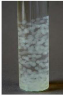
**Deutung 1:** Durch die zweifach positiv geladenen Calcium-Ionen werden die größeren Alginat-Moleküle miteinander verbunden. Dies führt zur Bildung eines Polymeren, das sich in der Form mit der geringsten Oberfläche manifestiert.
