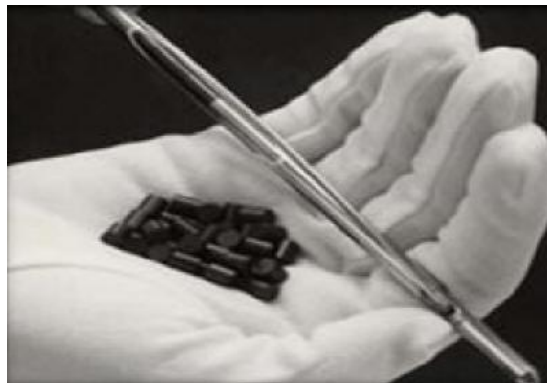
Abb. 10: Brennstab-Hülle mit Kern-Brennstoff in Tabletten-Form [10]
