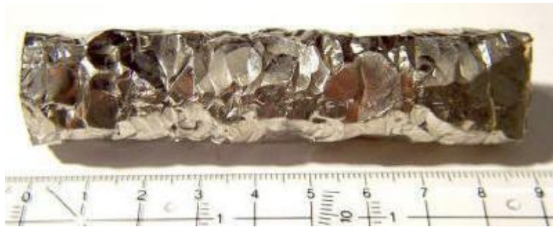
Abb. 7: „Crystal Bar“ aus 99,97% reinem Zirkonium [7]
