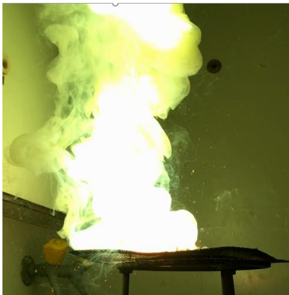
Abb. 6: Feuerball bei Entzünden des Pulvergemisches aus Zinkpulver und Schwefelpulver.
