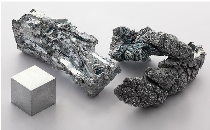
Abb. 7: Hochreines Zink, links als Würfel mit 1\text{ cm}^3 , in der Mitte als Bruchstück aus einem Barren und rechts sublimiert. [6]
