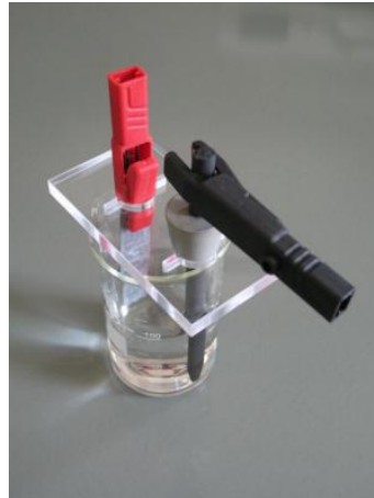
Abb. 6: Modell eines Blei-Akkumulators [4]
