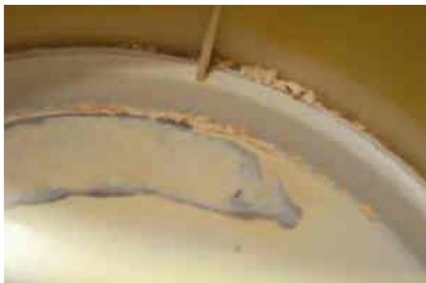
Abb. 2: Kalk-Ablagerung am Boden eines Wasser-Kochers
