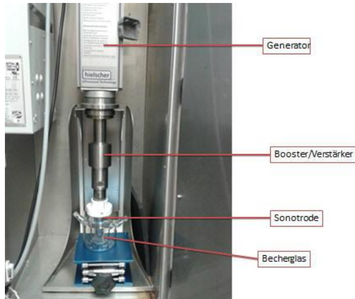
Abb. 3: Aufbau des Ultraschall-Prozessors [4]
