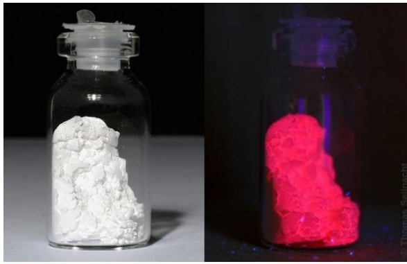
Abb. 2: Reines Europium(III)-oxid unter normalen Lichtbedingungen (links) und unter UV-Licht (rechts) [11].
