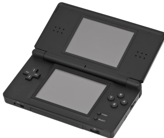
Abb. 1: Nintendo DS mit resistiven Touchscreen (unterer Bildschirm) [7]
