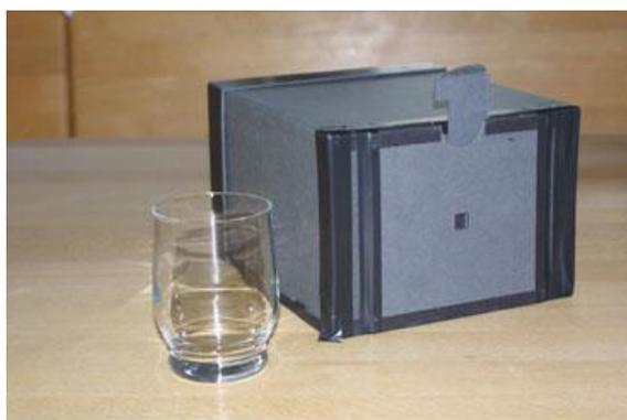
*Abb. 8: selbstgebaute Lochbild-Kamera nach [8]
