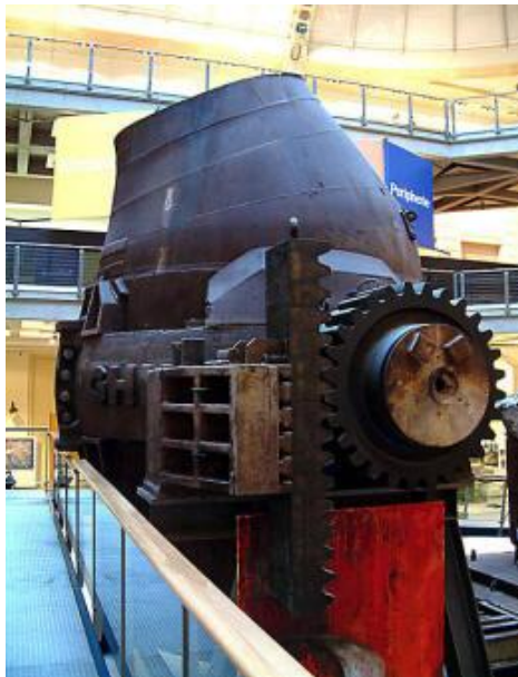
Abb. 6: LD-Konverter, 120 Tonnen schwer [1]
