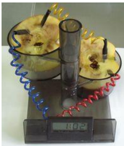
Abb. 1: Apfeluhr - zwei Apfelhälften (in Reihe geschaltet) sind über Kabel mit einer Digitaluhr verbunden
