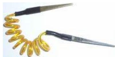
Abb. 2: Metall-Spieße (Elektroden) aus Messing (oben) und Stahl (unten), die leitend über ein Kabel verbunden sind
