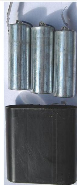
Abb. 2: Zerlegte Flach-Batterie mit 4,5 V [5].
