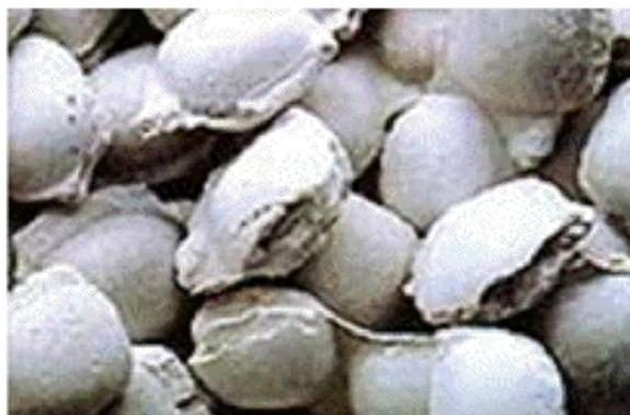
Abb. 5: Rauchgas-Gips nach dem Brikettier-Verfahren [4]
