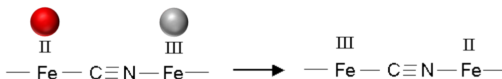
Abb. 12: Modell eines intramolekularen Redox-Vorgangs im Berliner Blau [2]
