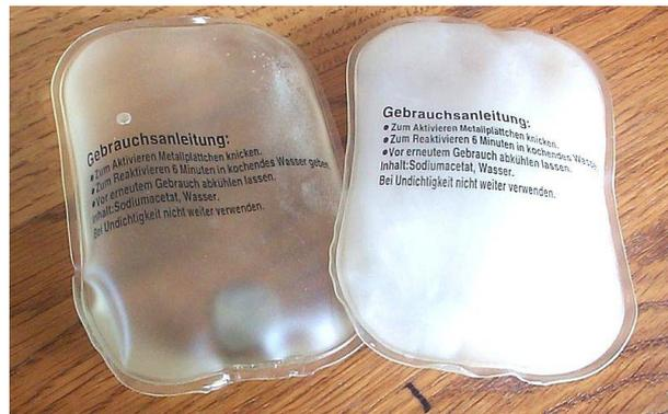
Abb. 1: Zwei regenerierbare Handwärmer, links im flüssigen und rechts im kristallisierten Zustand [8].
