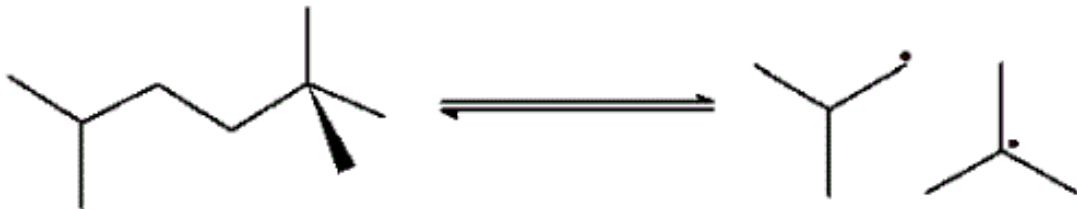
Abb. 7: Radikal-Entstehung durch den Zerfall einer Kohlenwasserstoff-Kette
