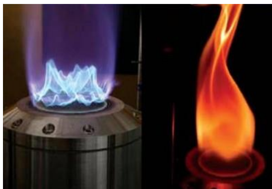
Abb. 3: Mischungstypen, links „vorgemischte“, rechts „nicht vorgemischte“ Verbrennung [1]
