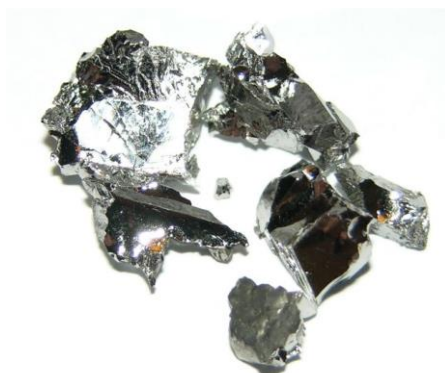
Abb. 3: Wolfram-Späne hoher Reinheit [7]
