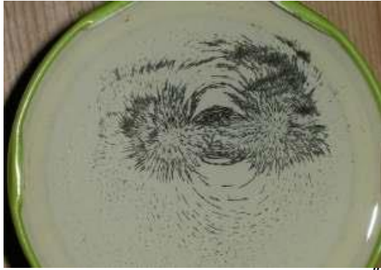
Abb. 3: Feldlinien-Versuch: Eisen-Späne in Öl [2]
