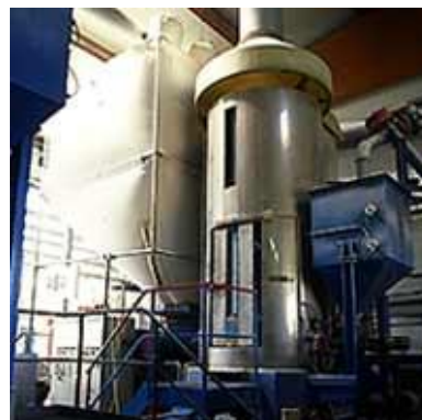
Abb. 12: Vorschäumen von Polystyrol-Granulat [4]
