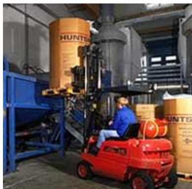
Abb. 12: Vorschäumen von Polystyrol-Granulat [4]
