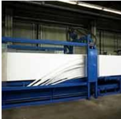
Abb. 16: Zuschneiden der Styropor-Blöcke [4]
