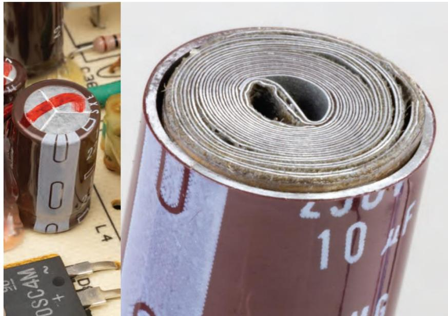
Abbildung 5: Folienskondensator mit aufgesägtem Querschnitt [1]
