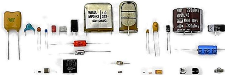
Abbildung 4: Verschiedene Arten und Bauformen von Kondensatoren [5]
