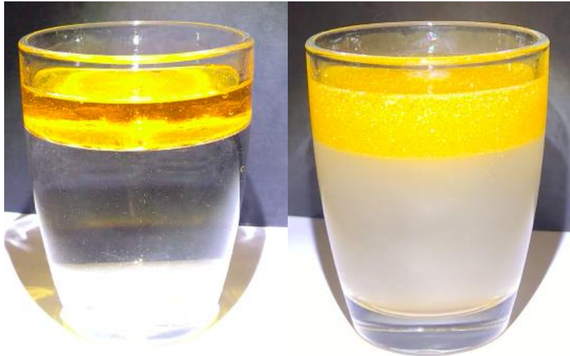
Abb. 2: Phasentrennung zwischen dem angefärbten Speiseöl und Wasser (links). Nach Hinzugabe von Spülmittel erfolgt eine Phasendurchmischung (rechts).
