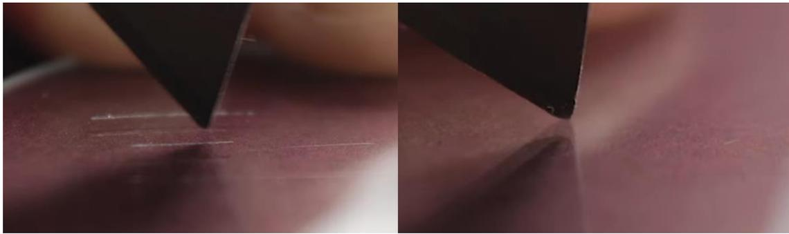
Abb. 3: Resultate des Kratzfestigkeitsversuches von Mineralglas (links,  $[\text{SiO}_2]$ ) und keramischem Saphir“glas“ (rechts,  $[\text{Al}_2\text{O}_3]$ )
