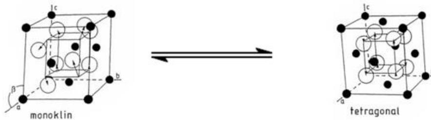
Abb. 8: Reversible und displazive Modifikationsumwandlung von Zirkoniumoxid während des Sinterprozesses
