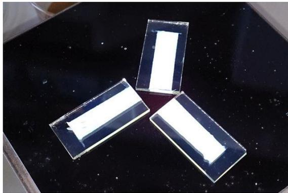
Abb. 3: Mit  $\text{TiO}_2$  beschichtete Anode zum Trocknen auf einer Ceran-Platte
