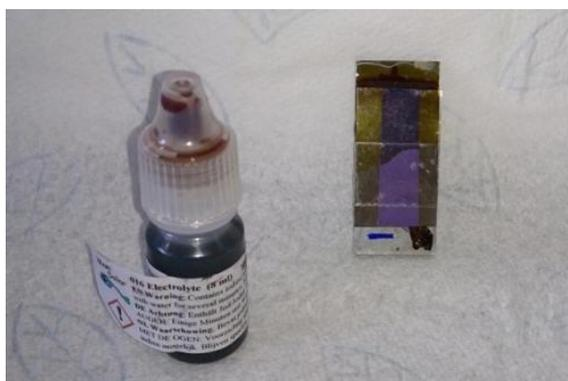
Abb. 7: Elektrolyt-Lösung zieht von oben zwischen die beiden Elektroden in die Zelle ein
