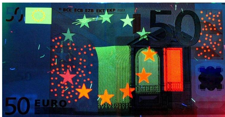
Abb. 4: Fluoreszenz-Bild der Vorderseite eines 50-Euroscheins [4]
