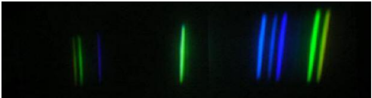
Abb. 5: Nachweis von UV-Licht durch Fluoreszenz - links: ohne Papier, rechts: mit Papier
