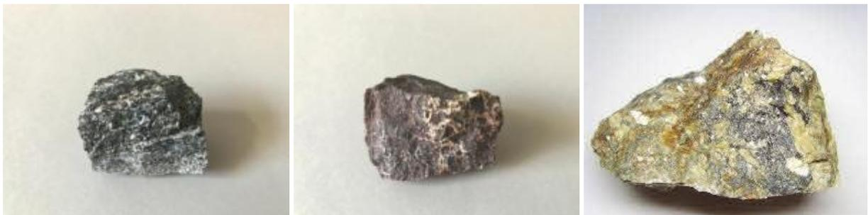
Abb. 3: Eisenerze Magnetit (links), Hämatit (mittig) und Siderit (rechts)[15]
