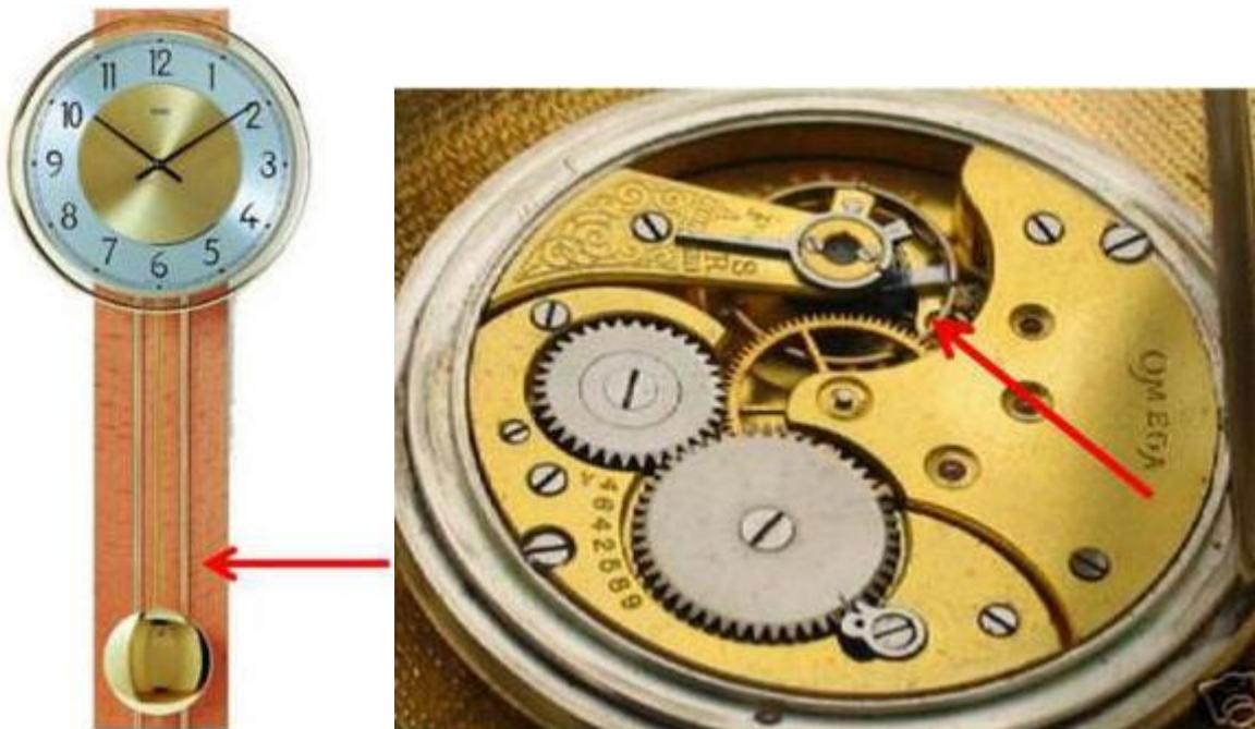
Abb. 1: links: Pendeluhr mit hin und her schwingendem Pendel (Pfeil) [1]; rechts: geöffnete Taschenuhr mit Drehpendel (Pfeil) [2]
