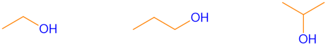
Abbildung 6: Gezeigt ist Ethanol (links), 1-Propanol (Mitte) und 2-Propanol (rechts). Dabei sind die hydrophoben Alkylreste gelb und die polare, hydrophile Hydroxygruppe in blau dargestellt.
