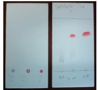
Abb. 9: DC-Platte vor (links) und nach (rechts) der Chromatographie (links und rechts wurden jeweils die Vergleichssubstanzen, in der Mitte das Gemisch aufgetragen)
