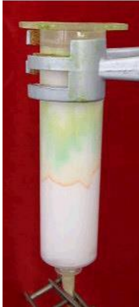
Abb. 4: Foto einer gefüllten Chromatographie-Säule [6]
