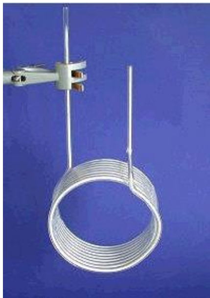
Abb. 5: Foto einer Glas-Kapillare zur Verwendung in einem Gas-Chromatographen [6]
