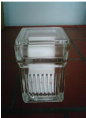
Abb. 7: Chromatographie-Kammer mit DC-Platte
