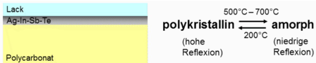
Abb. 8: Schematischer Aufbau einer CD-RW
