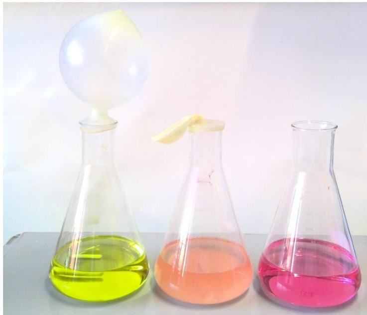
Abb. 4: 0,1 M Salzsäure mit Antazida (v.l.n.r. Bullrich's Salz, Maaloxan, Kontrolle)
