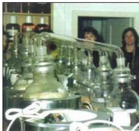
Abb. 10: Destillationsapparatur heute [9]
