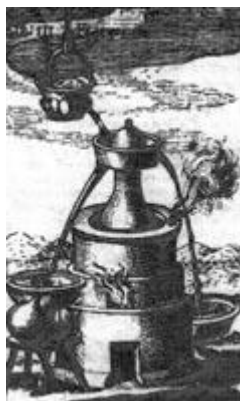
Abb. 8: Destillieranlage mit wassergekühltem Helm, dem „Mohrenkopf“. (Anonymer Kupferstich, 1625) [4]
