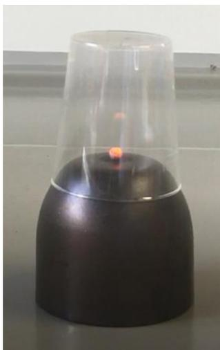
Abb. 6 Glühender Palladium-Platin-Katalysator während einer Knallgasreaktion
