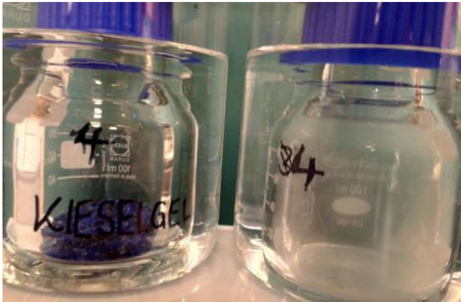
Abb. 3: Foto des Versuchs: Das rechte Glas ist angelaufen, das linke nicht
