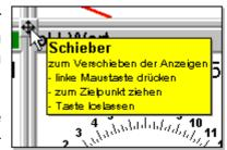
Klicken Sie mit der Maus auf die farbigen Rechtecke (an den Skalenenden), in denen die Meßgröße angezeigt wird. Es erscheint ein Kanalauswahlfenster. Klicken Sie auf den gewünschten **Kanalnamen**, das Fenster verschwindet und die Skala wechselt auf den selektierten Kanal.
